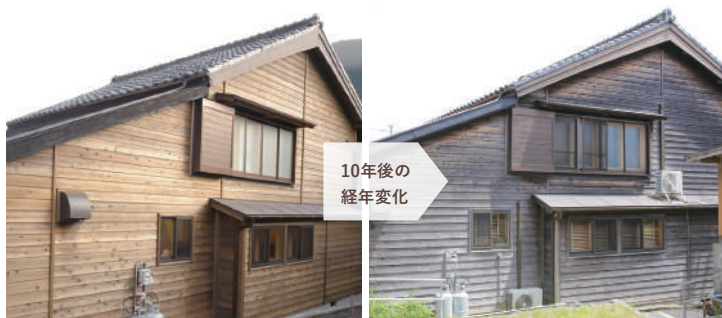
陽当たりが良く庇の短い面。紫外線がダイレクトにあたる西側ではシルバーグレイに変化します。
